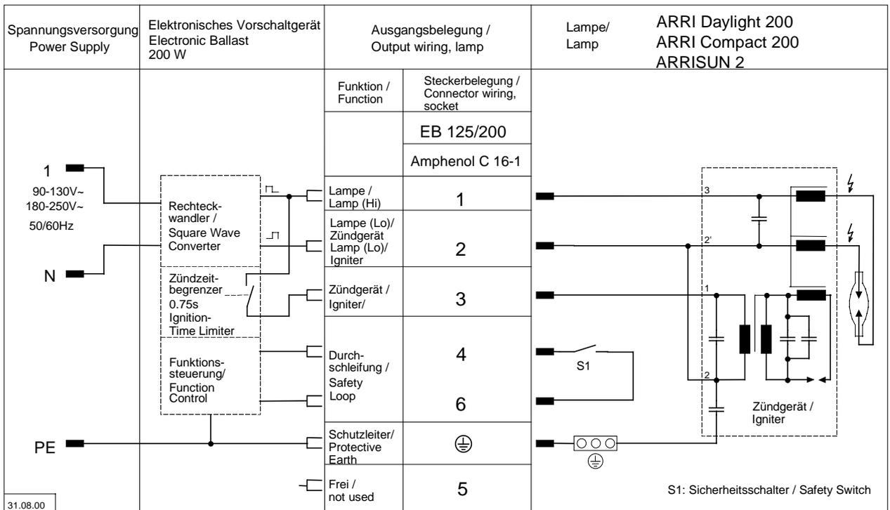
Abb./Fig. 1b: Anschlußbelegung 200 W /
