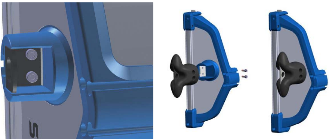
図 7: セーフティーループブラケットまたはサイドハンドルの固定
