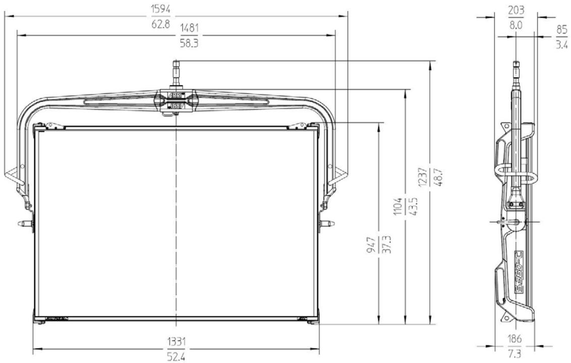
SkyPanel S360-C mit kurzem Stahlrohrbügel
