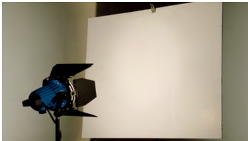
通过泡沫板（米波罗）反射ARRILITE的光
