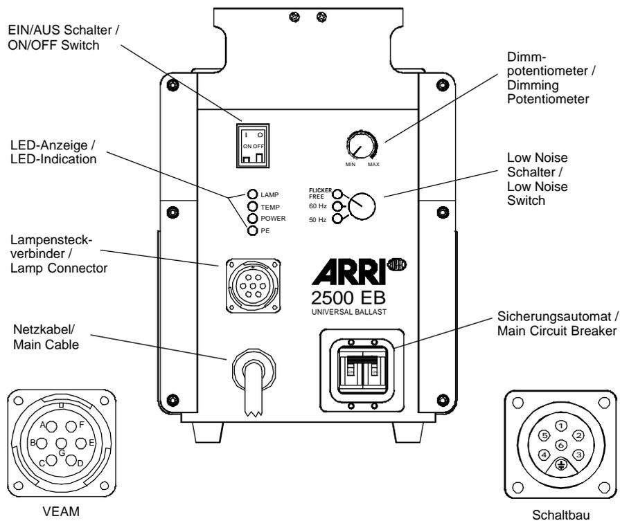
Abb./ Fig. 2: Bedienelemente auf der Frontplatte
